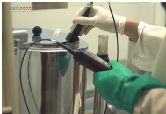
RYS. C PO LEWEJ: PRZYGOTOWANIE ROZTWORU DO WYTRAWIANIA PŁYTEK CR-39 UWIDACZNIAJĄCEGO ŚLADY CZĄSTEK ALFA, PO PRAWEJ: WYJMOVANIE WYTRAWIONYCH PŁYTEK Z ROZTWORU
