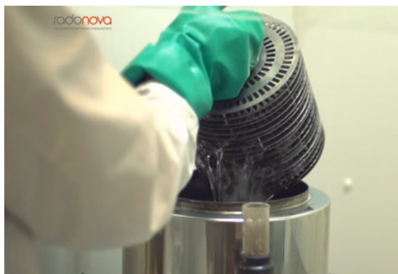
RYS. C PO LEWEJ: PRZYGOTOWANIE ROZTWORU DO WYTRAWIANIA PŁYTEK CR-39 UWIDACZNIAJĄCEGO ŚLADY CZĄSTEK ALFA, PO PRAWEJ: WYJMOVANIE WYTRAWIONYCH PŁYTEK Z ROZTWORU
